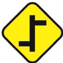
Empalmes contrarios sucesivos
