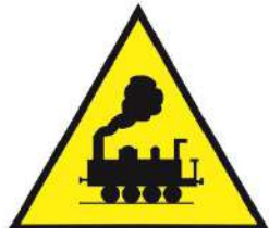
Cruce ferroviario con o sin barreras
